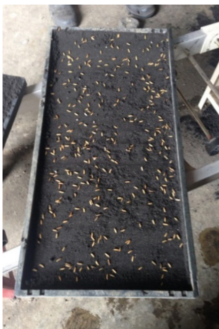
Figura 7. Distribución de semillas por la llenadora de bandejas.
