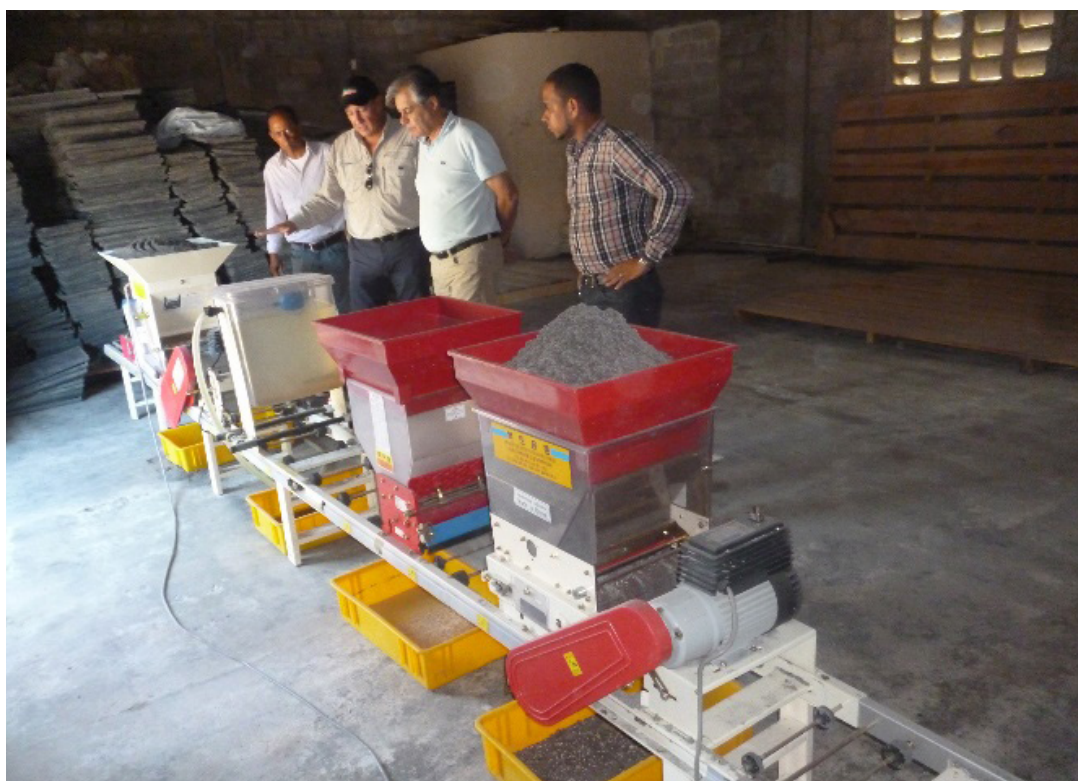
Figura 9. Ciclo completo de llenado de bandejas con sustratos.
